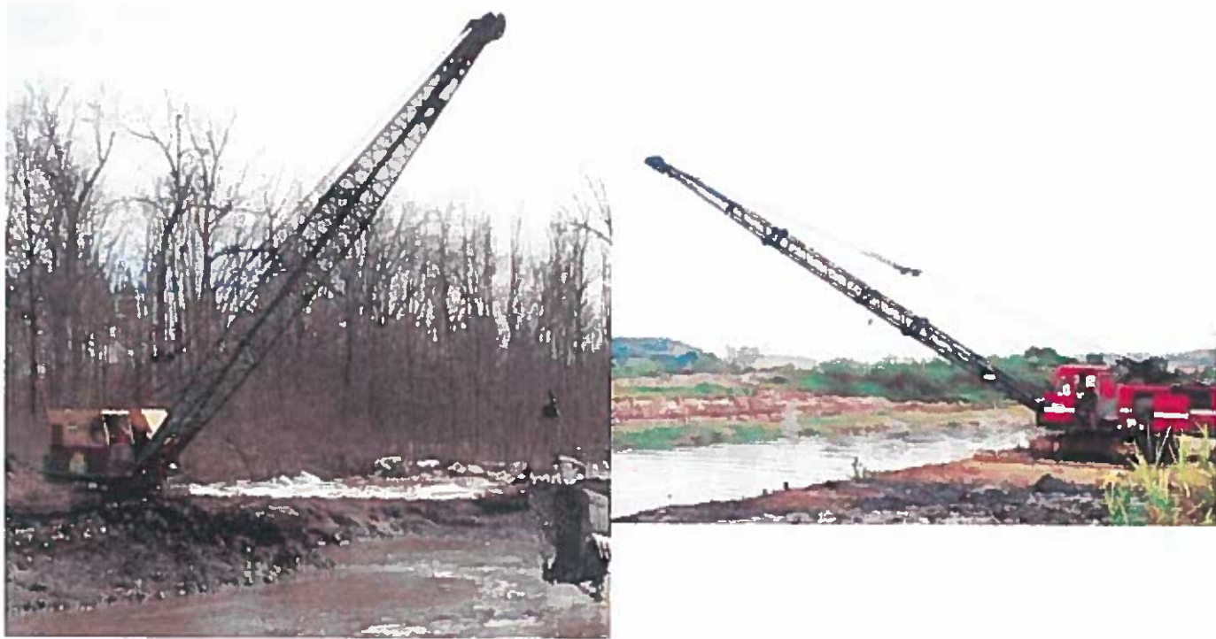
Figura 7.3 – Escavadeira de Caçamba (Drag-Line) em operação.
